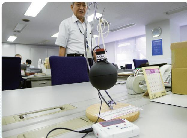
1階オフィスにある測定器は、ゴム製の丸いケースに温湿度計が仕込まれ、ケーブルを通して外のデータロガーに測定値が送られる。同様の機器が窓際も含めて幾つも設置されている
