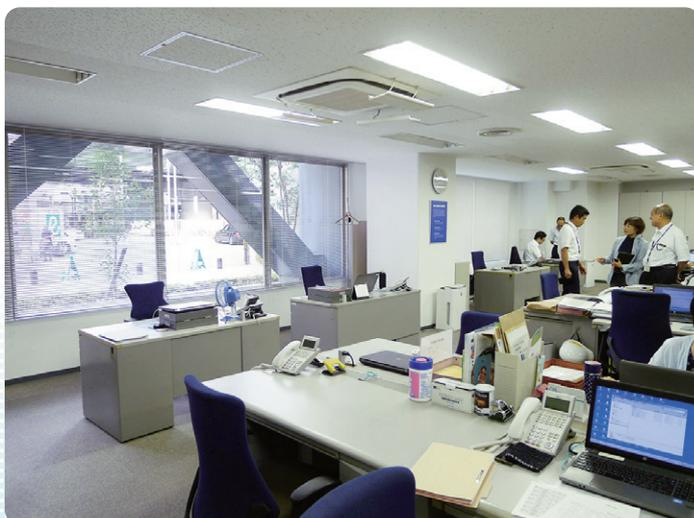
西面のFIX窓が真空ガラスに交換された1階オフィス。この階のみ全体計画から先行して工事し、エコガラスの性能を再確認した
