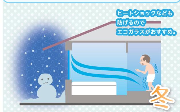
日射のない北面の窓にもエコガラスは有効です。エコガラスの断熱性能は透明複層ガラスの約1.7倍! 外から伝わる冷気を防ぎます。冬の夜、北向き窓が多い浴室や脱衣室などの冷えから家族の体を守ってくれるのです。
