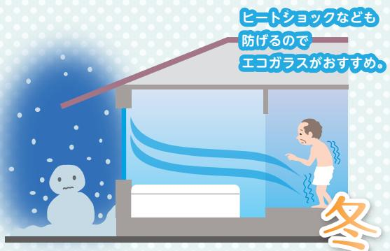
日射のない北面の窓にもエコガラスは有効です。エコガラスの断熱性能は透明複層ガラスの約1.7倍! 外から伝わる冷気を防ぎます。冬の夜、北向き窓が多い浴室や脱衣室などの冷えから家族の体を守ってくれるのであります。
