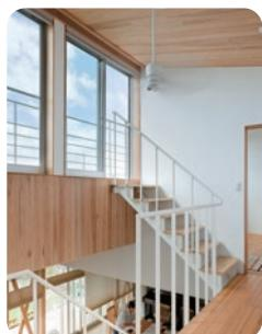
日射遮蔽型エコガラスの窓が並ぶ、2階吹抜けスペース。逆勾配の庇は目に入らず、さざげるもののない青空をのぞむことができる
